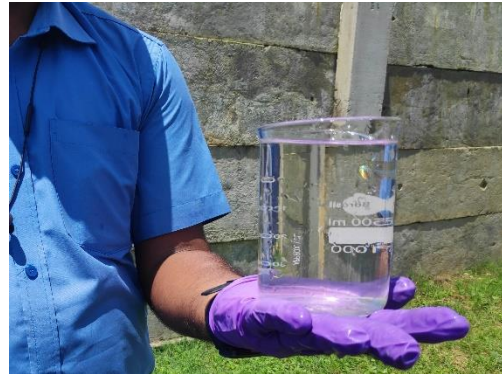
Effluence from STP
