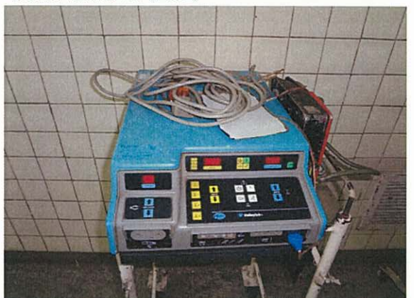
1990年代に保健省が調達した電気メス。現在も使用しているが、機能低下が著しい。
