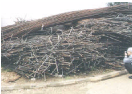
(左) 交換されたチューブ 11,780 本が構内に積まれている。(右) 冷却管の端末処理
