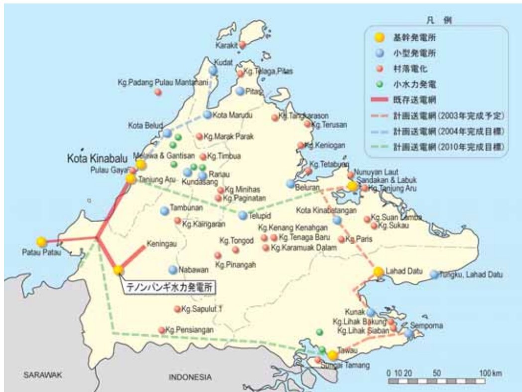
図1: サバ州電力供給体制(発電所と基幹送電網)とテノンパンギ発電所の位置
