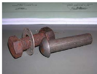
ットは国内製造品を確実に調達できる資材であるため、維持管理に迅速に対応できるメリットがある点も強調していた。また、ボルトは緩んだときに盗難に遭いやすい。現場が不慣れな技術を導入する際には、実施機関による事前の十分な説明、関係機関との調整、ボルトを扱う検査・維持管理要員を養成するトレーニング、維持管理のための資材の調達ルート確保等が重要である。
