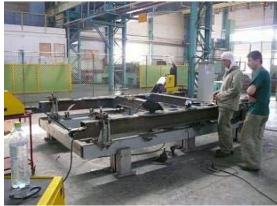
客車修理工場（左：取り外された車輪・車軸、右：客車製造のため試作中の台車）
