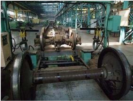
客車修理工場（左：取り外された車輪・車軸、右：客車製造のため試作中の台車）
