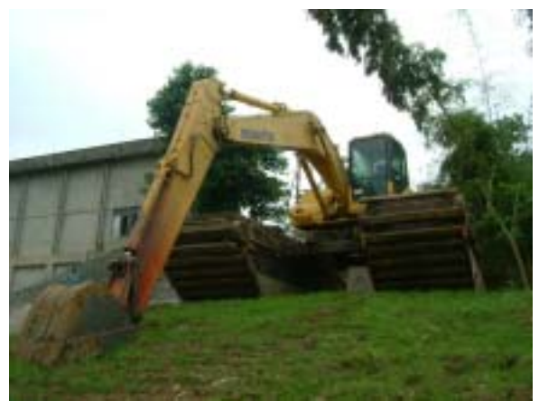
水陸両用掘削機
