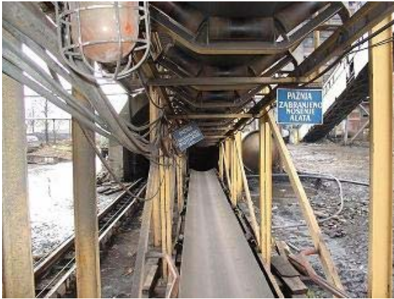
主坑道のコンベヤーと地下坑内の石炭掘削運搬設備（ブレザ炭鉞）
