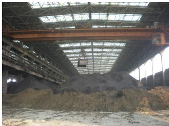
図 13 乾燥汚泥と石炭の混合
