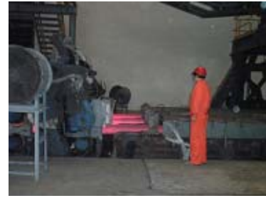
連続鋳造設備
