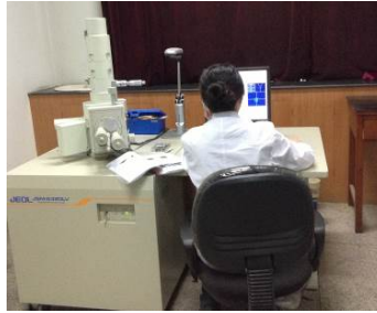
走査電子顕微鏡。使用頻度は 非常に高いとのこと。 (蘭州大学医学院)
