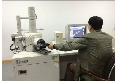
走査型電子顕微鏡を使って筋肉の分析を実施中。学内のコンペで選出された研究チームでもある (重慶医科大学)
