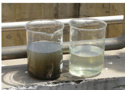
図 1 臨江溪下水処理場の 処理前 (左)・処理後の水 (右)
