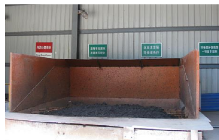
図3. 汚泥の乾燥・粉砕 (汚泥リサイクルの最初の工程)
