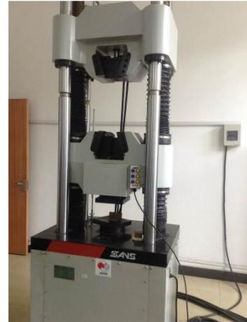
材料科学工学学院金属材料加工重点実験室の油圧サーボ万能試験機（安徽工業大学）
