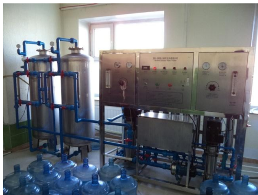
本事業の融資で購入した純水製造機（ウランバートル郊外のミネラルウォーター製造業者）
