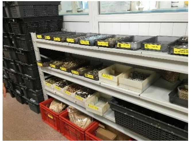
カイゼン指導により残量が一目で分かるように整理された部品類 (ビジネスコース修了生所属企業)
