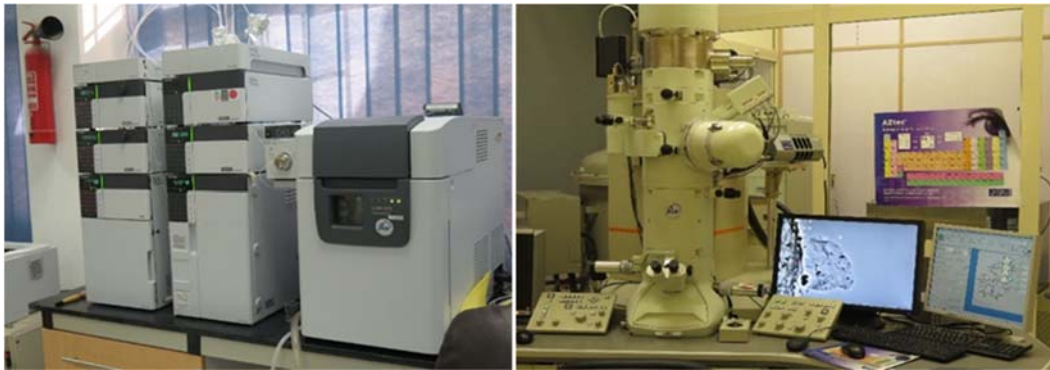
高性能な質量分析が可能な液体クロマトグラフ 工学材料等の微小領域の分析に使われる透過型電子顕微
