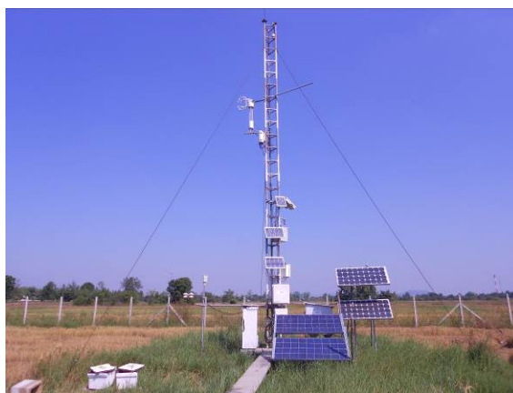
写真1 ラチャブリに設置された フラックス観測塔
