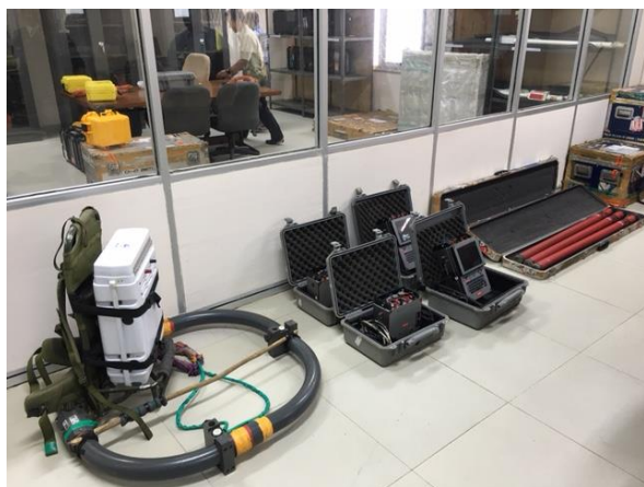
本事業の供与機材（MT/時間領域電磁探査・MTの測定機材）
