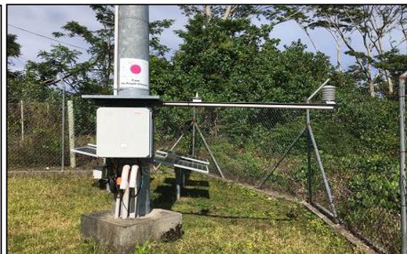
データ処理収集装置、気圧計及び温度計・湿度計
