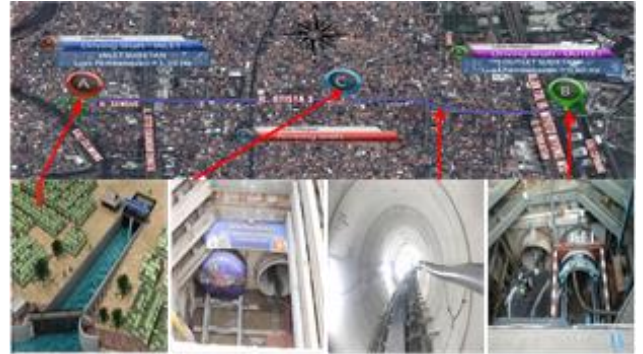
チリウン川から東放水路への地下放水路により 洪水ピーク流量 60 m 3 /秒が減少
