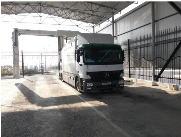
ウズベキスタン - アフガニスタン国境のアイリトンに配備された車 載型大型 X 線検査機 (2016年10月3日から運用停止していたが2017年2月7日に再稼働)
