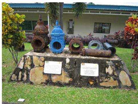
本事業で改修された錆びた配水管と新たに設置された配水管のモデル（プレアシハヌーク）
