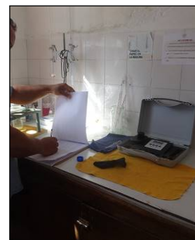
ピラール浄水場： 濁度と色度の検査・記録 をするオペレーター
