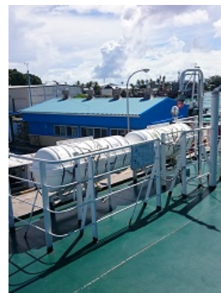
写真 2 船内に設置された膨張式救命筏
