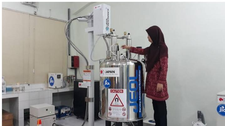
化合物の構造解明を行う核磁気共鳴装置の機材を説明する研究者
