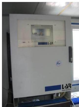
黒河金盆ダム湖の上流域に設置されている毒物センサー。 設置後、現在まで故障は起きていない。
