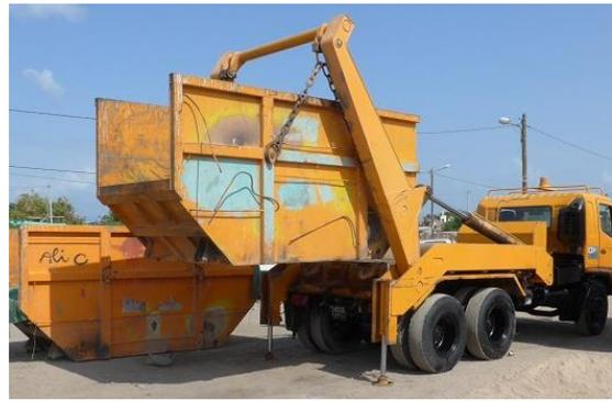
レールのパーツが欠損しているトレーラー サイドバーが破損している 10 m<sup>3</sup>コンテナ
