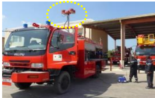
照明塔が下がらなくなった救助車
