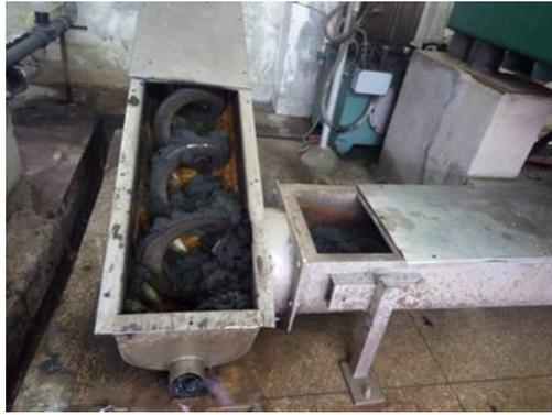
北区下水処理場の汚泥脱水処理
