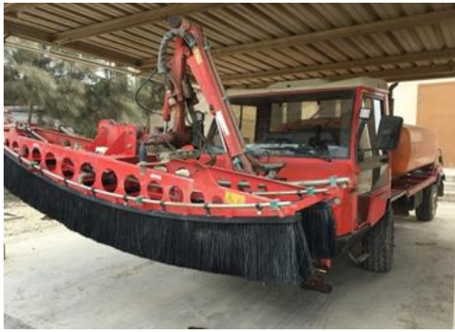
写真 1: 太陽熱集熱器の専用清掃車両
