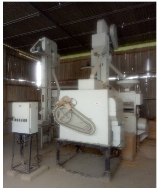
ライスセンターの精米機
