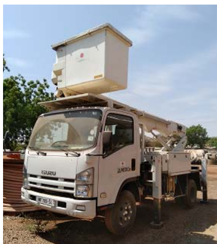
高所作業車（タマレ地区）
