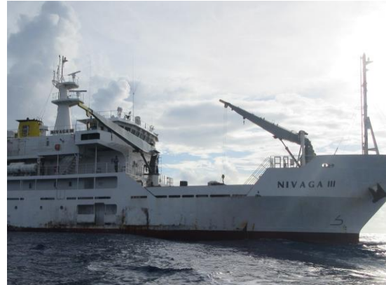
船体側面（錆や塗装の剥がれ）
