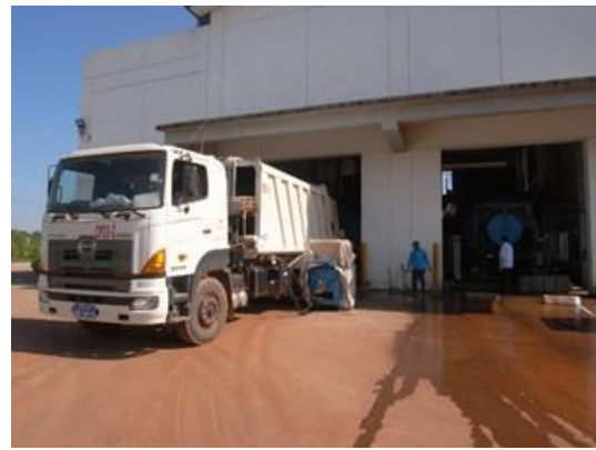
写真 3. 同左（最終処分場への運搬を行う大型（20m 3 ）コンパクター車への積み替えの様子）
