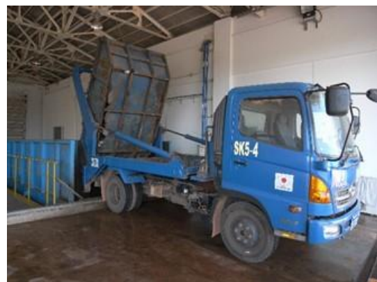
写真1. ビエンチャン廃棄物輸送中継基地での積替え作業（スキップローダー車）
