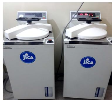
供与機材の高圧蒸気滅菌器
