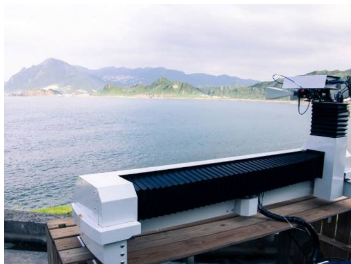
写真 2 (MMU 提供) : MMU では、SAR サブシステムを活用して、土地の変形を検出するための地上ベース SAR (GBSAR) の開発を進めている。GBSAR は CP/SAR に比べて検出精度が高く、自然物や人工物のサブミリ単位の動きを検出することができる。
