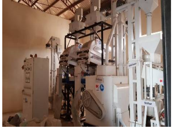
ナサラワ州ラフィアに設置された 1.5 トン/時間の近代的な精米機
