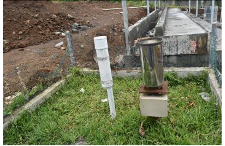
カトルスールの雨量計 MPIによるモニタリング体制の補完として モーリシャス気象局が設置した
