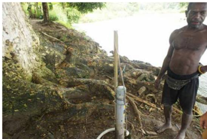
豪雨により損傷を受けた簡易水位計（タンボコ村） (ソロモン諸島)
