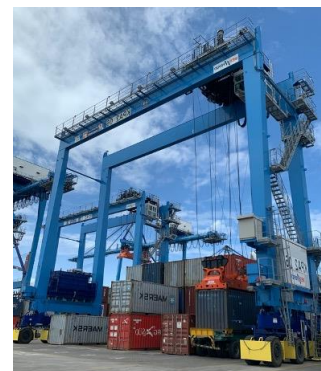
本事業にて整備・調達された コンテナヤードと RTG
