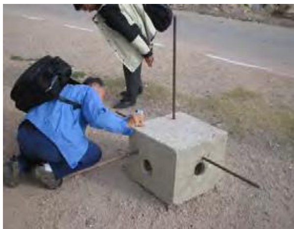
本事業により準備された、改善された人工魚礁
