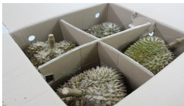
段ボール箱：本事業で設計された新鮮なドリアン用の輸送包装
