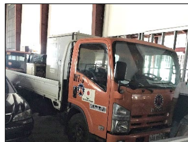
写真3 排水ポンプ車 (Region III Pampanga、 San Fernando)
