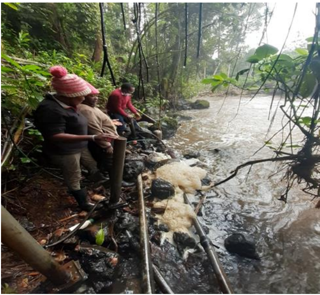
ラガティ川に設置した水槌ポンプを点検する女性
