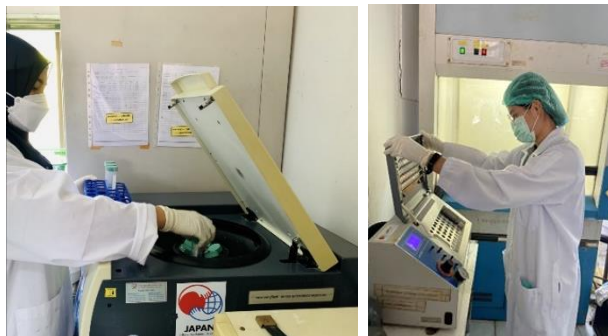
水産局での供与機材を使った研究の様子 (左：卓上型遠心分離機、右：窒素蒸発装置)
