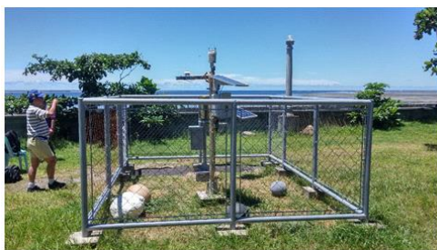
レーダー校正と降水量予測のために設置された自動雨量計
