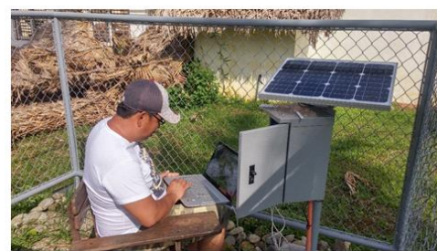
レーダー校正と降水量予測のために設置された自動雨量計
