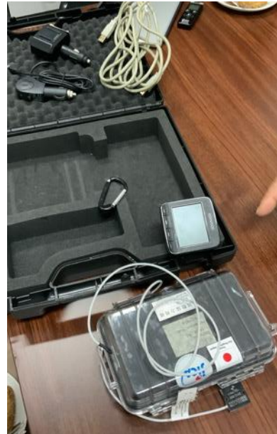
写真4 道路維持管理コンポーネントで供与された移動路面モニタリングシステム（DRIMS）。BARM 公共事業省が路面のラフネス測定に使用。状態は良好で、持ち運びもしやすい。 （出典：事後評価者撮影）
