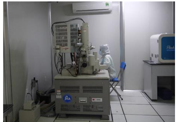
ホーチミン市の INT に設置された電解放出型走査電子顕微鏡
