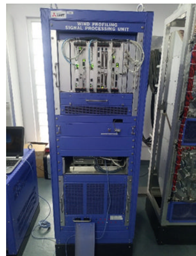
写真4：ウィンドプロファイラシステム (一部) (ムルタン国際空港内 PMD 気象事務所) (出典：現地調査補助員撮影)
